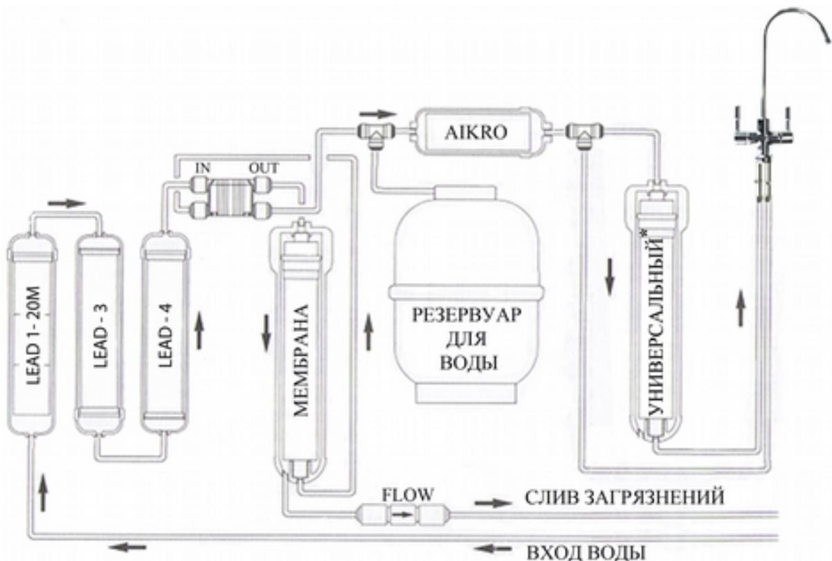
\* Еврокартридж УНИВЕРСАЛЬНЫЙ Зв1 подключается к любой фильтрующей системе, расположенной под кухонной мойкой. Подключение по схеме проводится последним, перед краном с очищенной водой.
